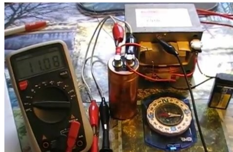
Spannung am Kondensator nun bei 11V obwohl die Quellbatterie bei 5,15V war (leer).
