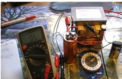
Kurz nach dem Ausschalten, Multimeter geht in Overload Flux bricht zusammen, Kompass pendelt sich aus
